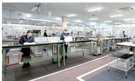
不具合が許されないエアバッグクッションの製造工程は、無理に自動化せず人の力を生かした生産体制
