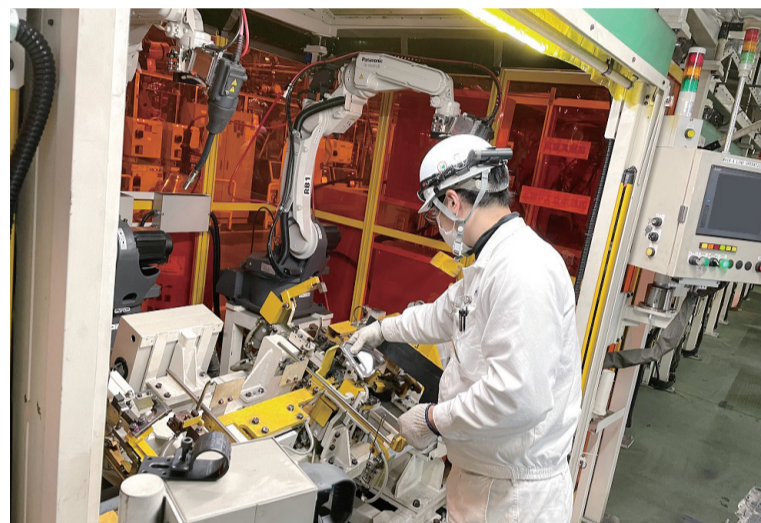
自動機やロボットがプレス・溶接したパーツは丁寧に検品
